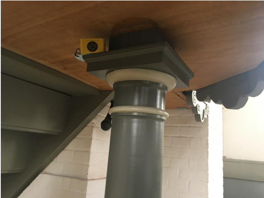
Figur 2. Datalogger til måling af temperatur og relativ luftfugtighed placeret under prædikestol i Bording kirke
